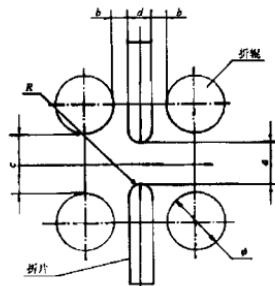
4.5.3 折叠头工作过程中，各运动零部件动作应灵活，不应有摩擦阻滞现象，折叠区温升不宜过高，耐折仪连续运转4h后，折叠头及周围环境温度应不超过试验室的平均温度1℃以上。
